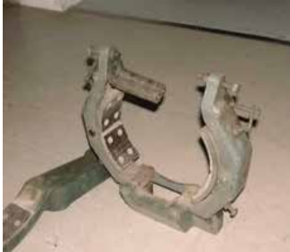
Amiante dans les freins – risque de maladie s'ils sont manipulés sans aucune précaution
