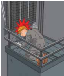
Risque d'écrasement par un organe en gainé lors du déplacement (contrepois, patte à guide, roller...)
