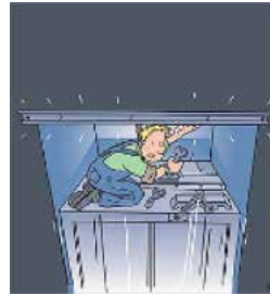
Risque d'écrasement en haut de gainé si l'espace disponible est insuffisant
