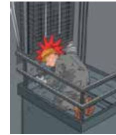
Κίνδυνος σύνθλιψης από εξοπλισμό κατά την κίνηση του θαλάμου στο φρεάτιο (αντίβαρο, στηρίγματα κλπ).
