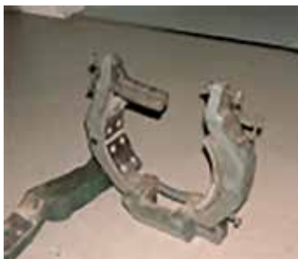
Αμίαντος στα φρένα – κίνδυνος σοβαρών επιπτώσεων στην υγεία εάν η επένδυση των φρένων αφαιρεθεί χωρίς προφυλάξεις.
