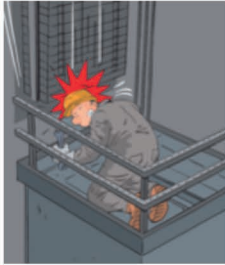
Zagrożenie zgnieciem przez sprzęt podczas ruchu kabiny w szybie (przeciwwaga, wspornik itp.).
